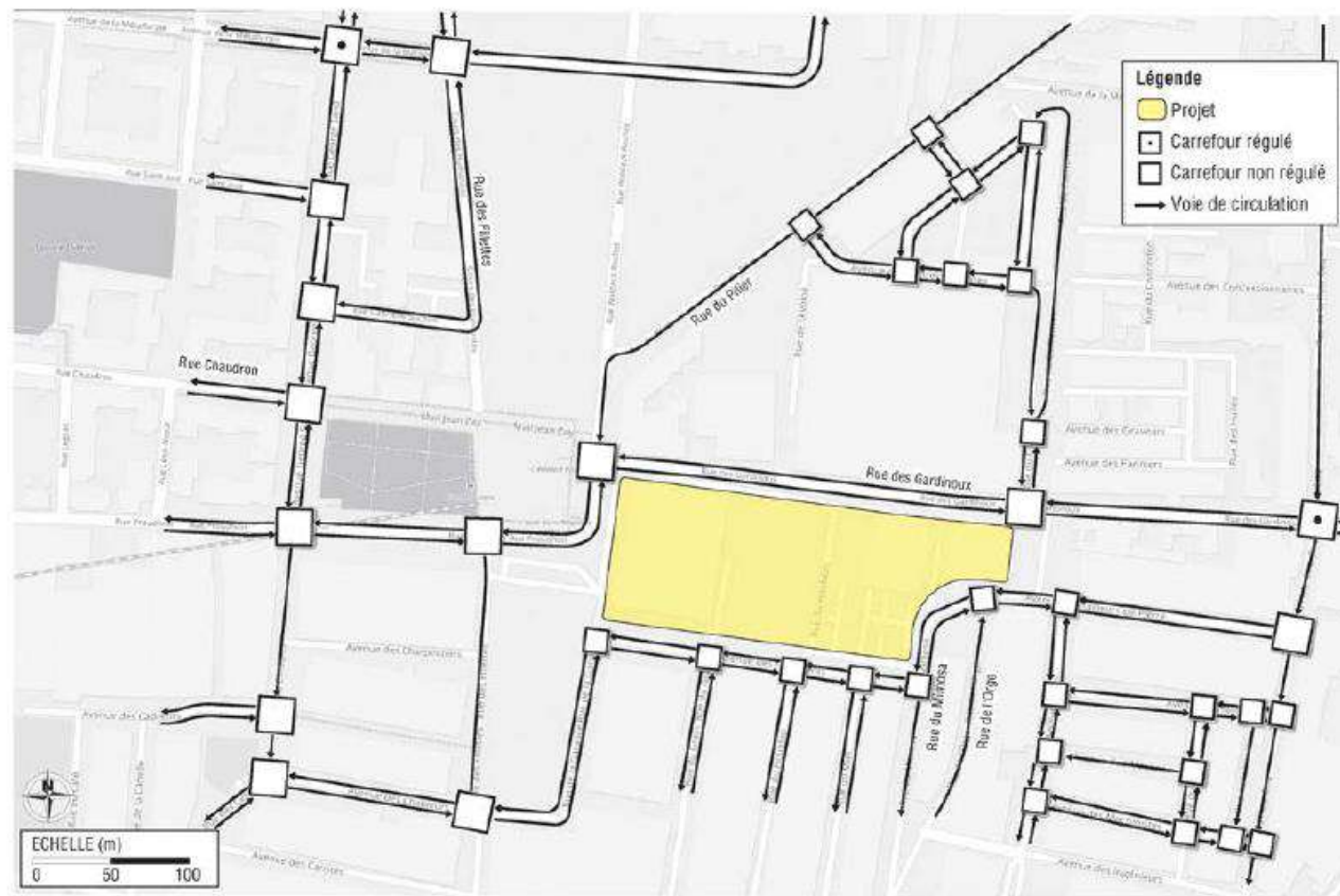
Figure 32 : Plan de calibrage et offre routière actuelle au droit du projet (Transitec, 2020)
