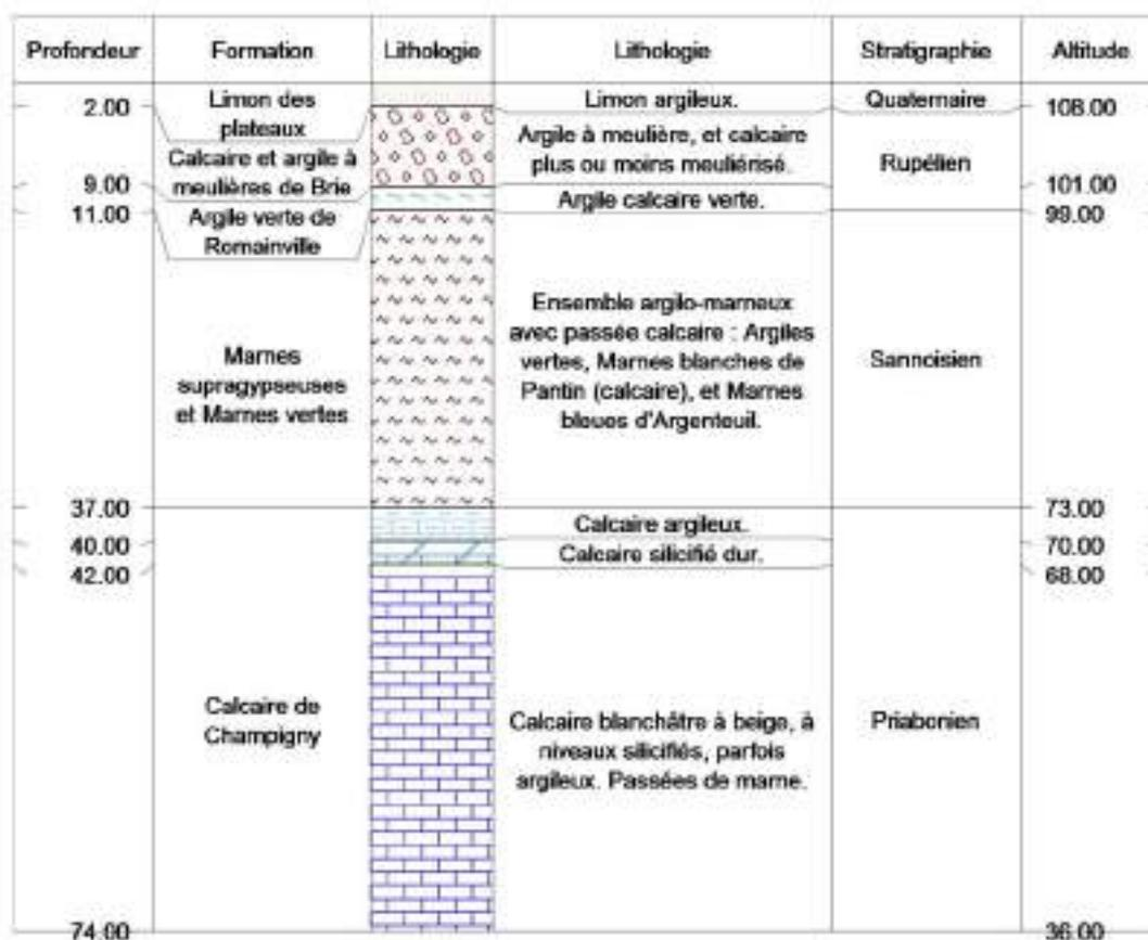
Figure 11 - Log géologique vérifié avec documents du sondage BSS000RPYX – Dossier du Sous-sol (BSS)
