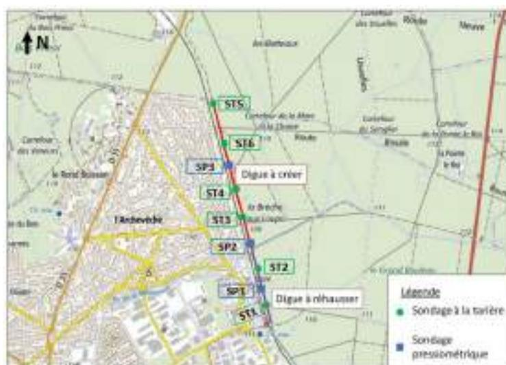
Figure 12 : Localisation des sondages et relevés piézométriques
