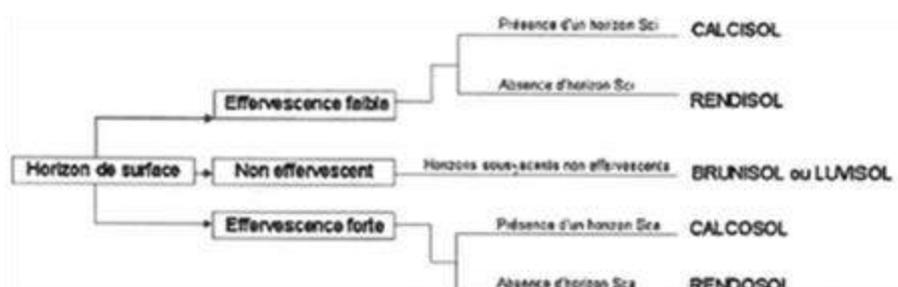
Figure 119 - Détermination du type de sol en fonction de l'effervescence à l'acide chlorhydrique
