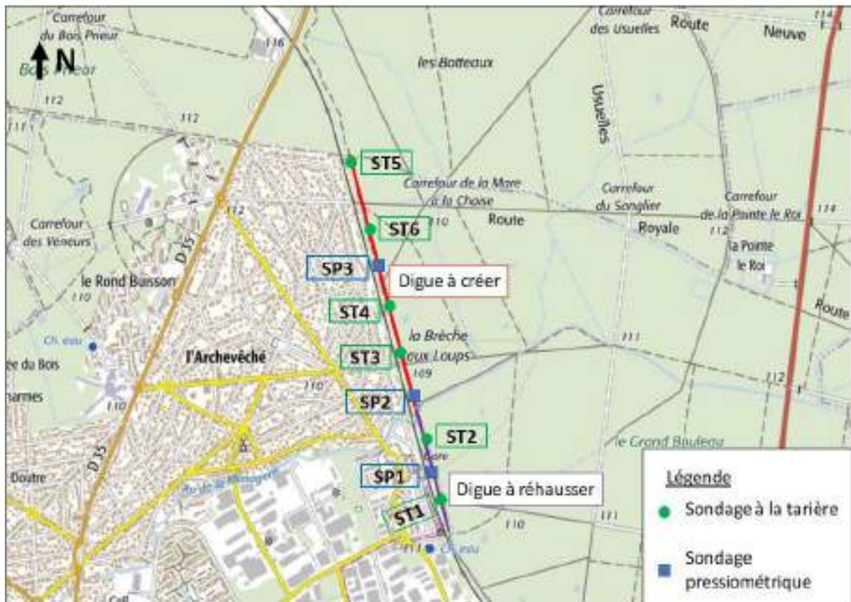
Figure 75 : Plan d'implantation des sondages (Source : Antea Group)
