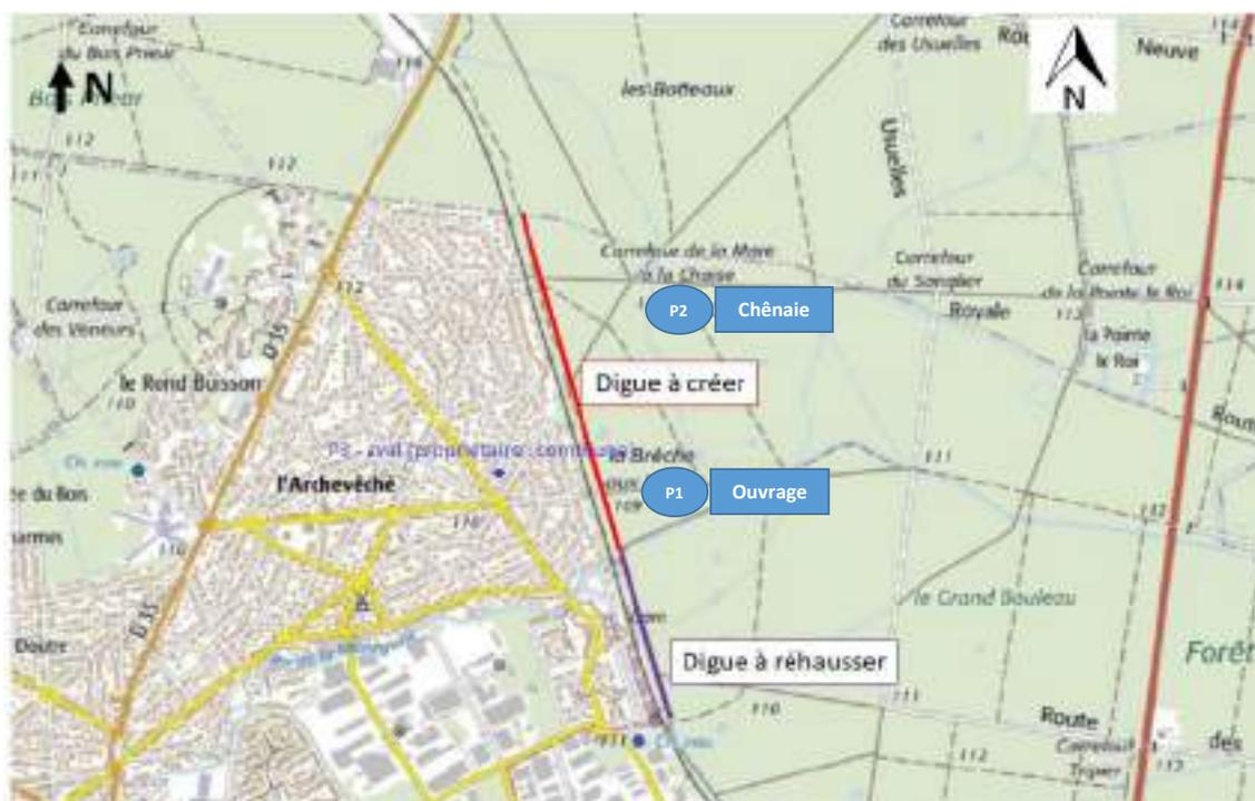
**Figure 91. Localisation prévisionnelle de l'implantation des piézomètres de suivi qui seront installés, équipés et entretenus par le SyAGE**
