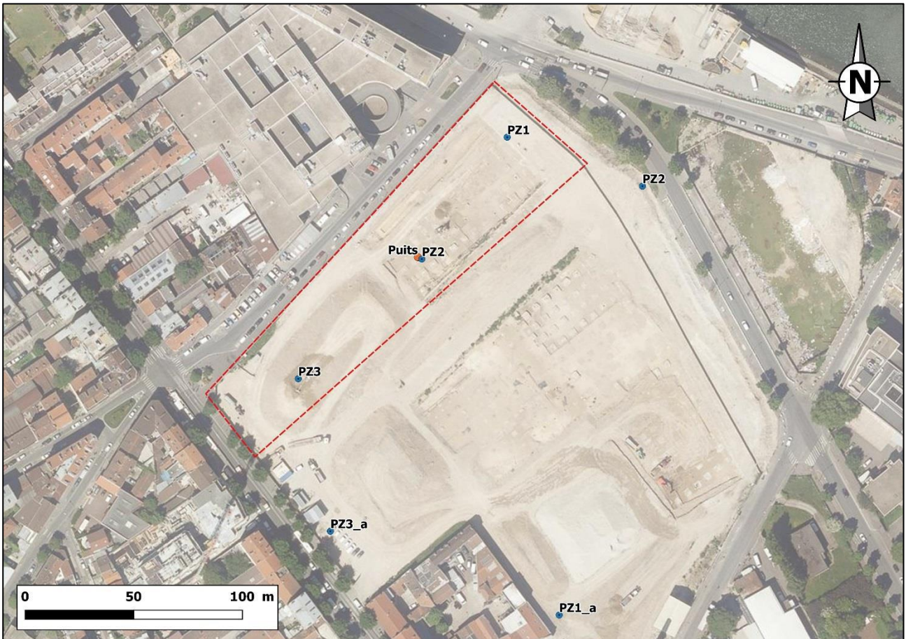
Figure 28 : Localisation des piézomètres et puits de pompage au droit du site
