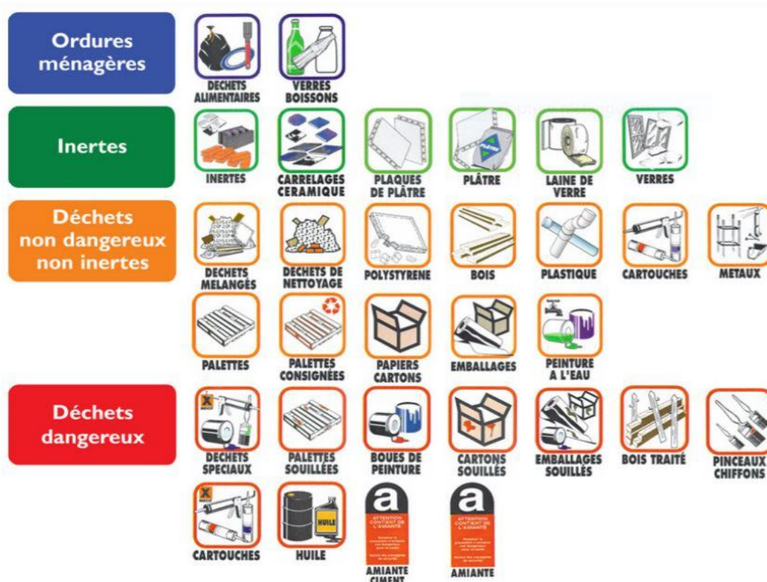
Rappel de la classification des déchets susceptibles d'être émis par un chantier.
