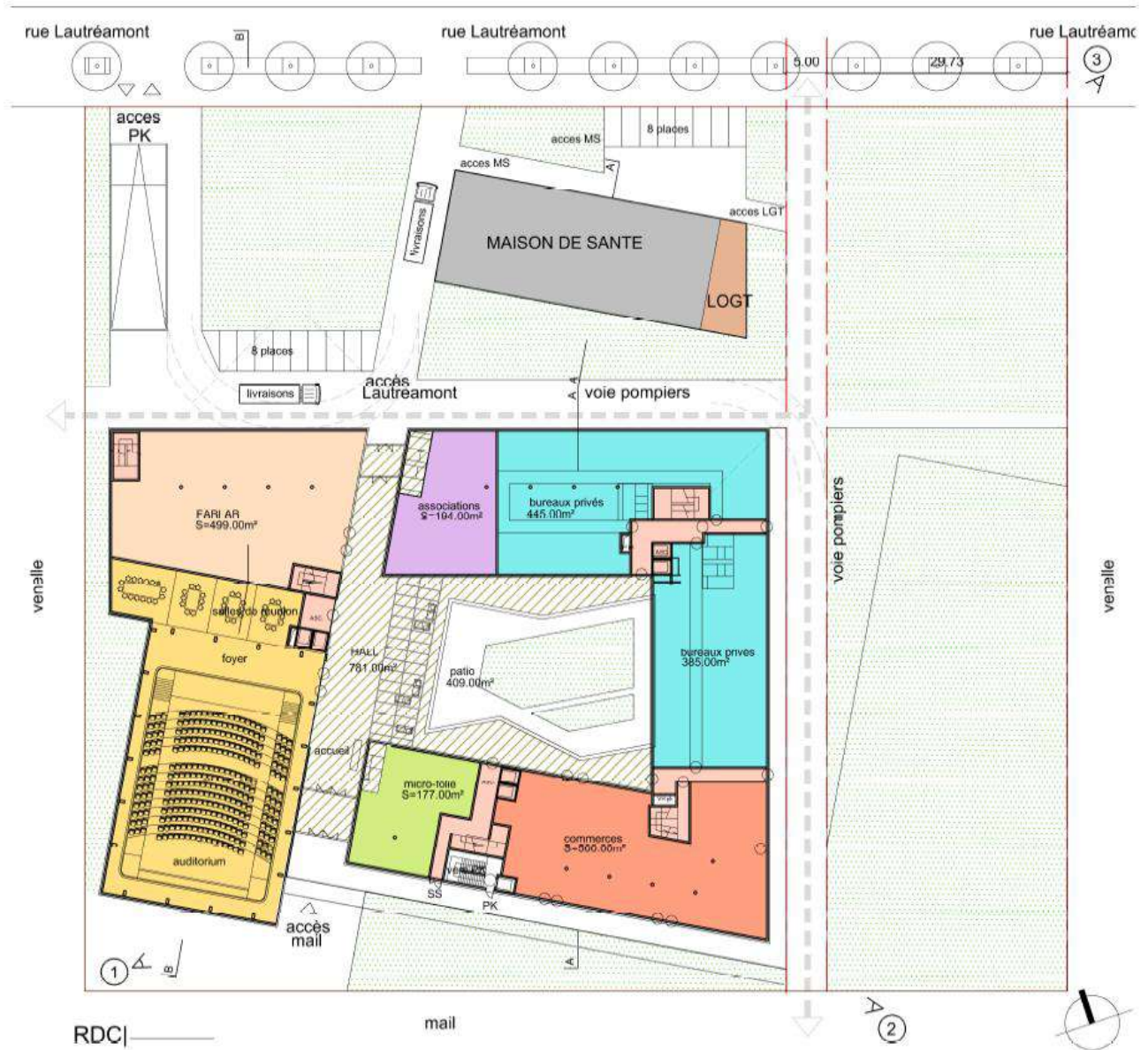
Figure 7 : RDC – Partie Handilab
