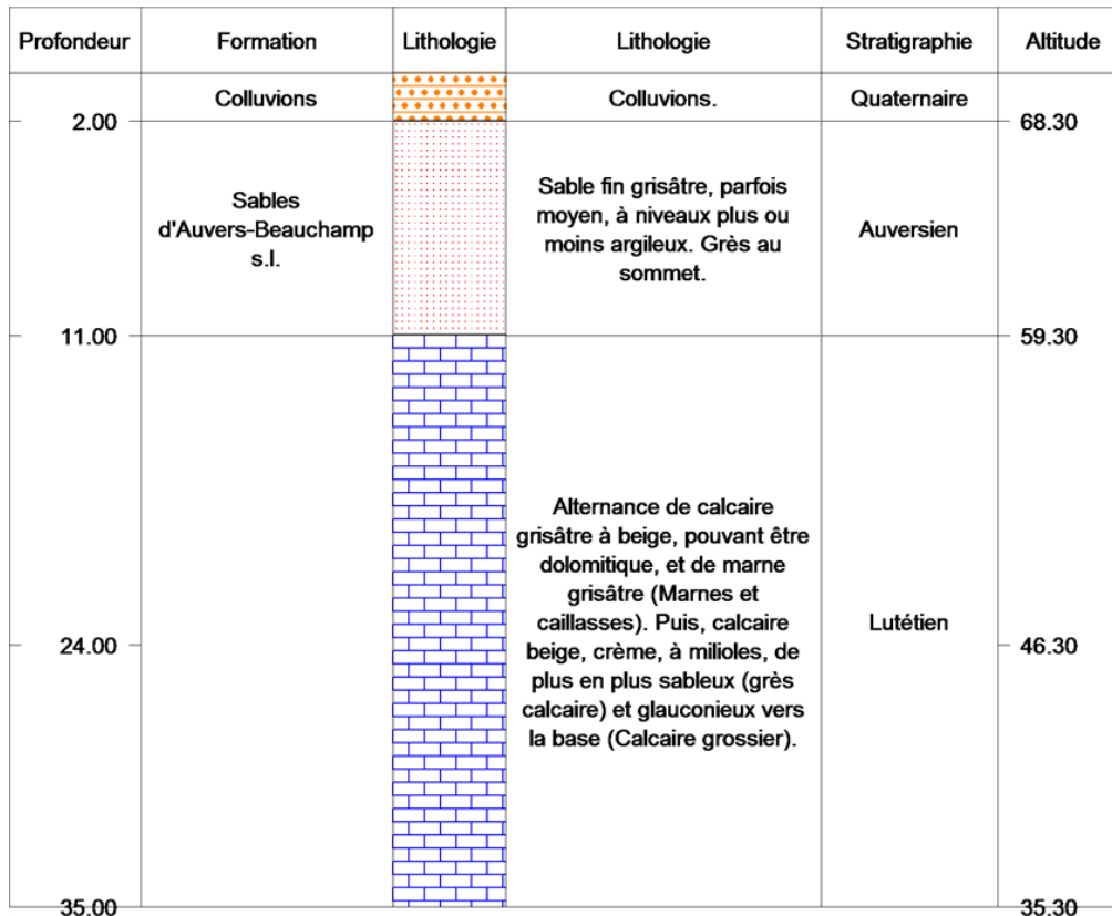
Figure 6 : Log géologique du sondage ((BSS000LPPY)
