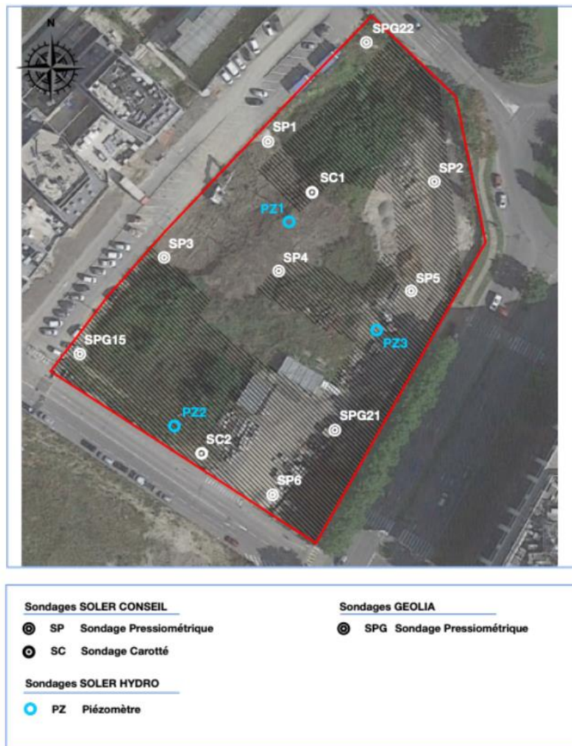
Figure 26 : Schéma d'implantation des sondages
