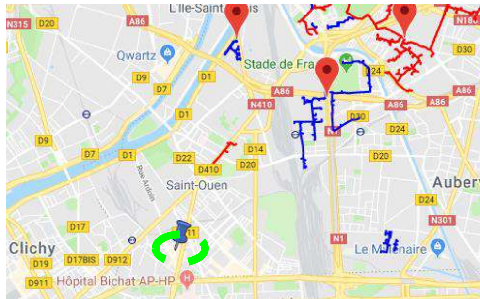
Figure 39 : Réseau de froid (en bleu) (source : SMIREC)
