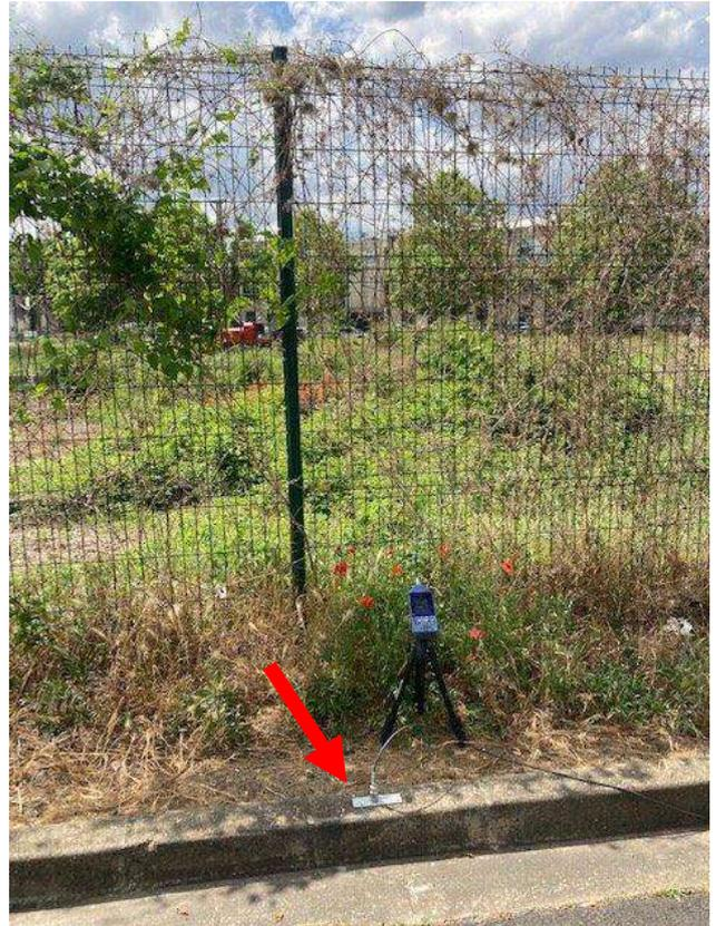
Capteur sur trottoir maçonné
