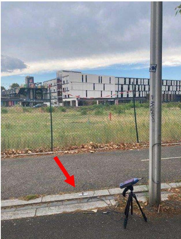
Capteur sur trottoir maçonné (mesure arrière projet)
