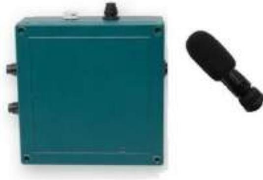
Figure 3 – Détecteur et enregistreur d'ultrasons
