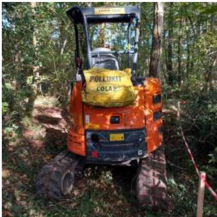
Figure 29 – Kit anti-pollution sur un chantier de mesures compensatoires près d'Angers, ARP-Astrance 2021
