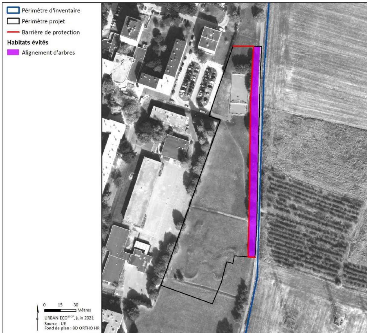
Figure 88. Localisation des clôtures de protection à implanter pendant les travaux d'aménagements (URBAN-ECO SCOP , 2021)
