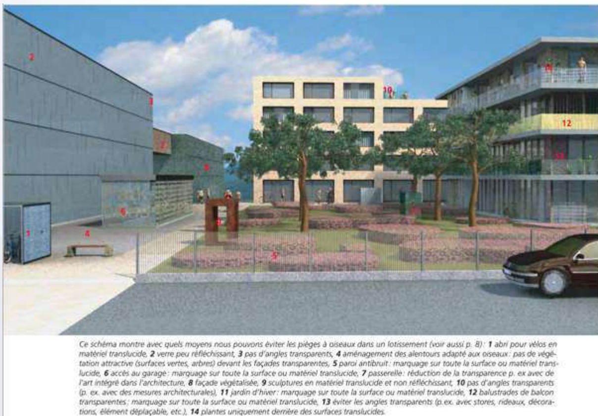
Figure 19 : Illustration des solutions existantes pour limiter le risque de collisions des oiseaux sur les surfaces vitrées.
