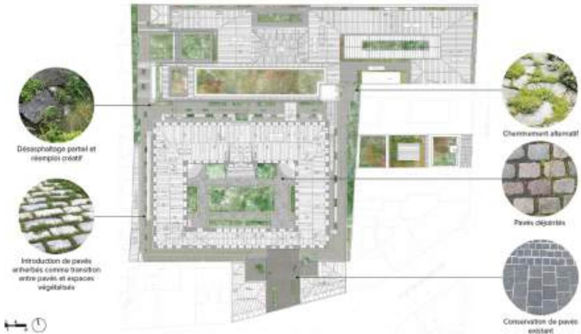
Fig.7 : traitement des sols, état projeté
