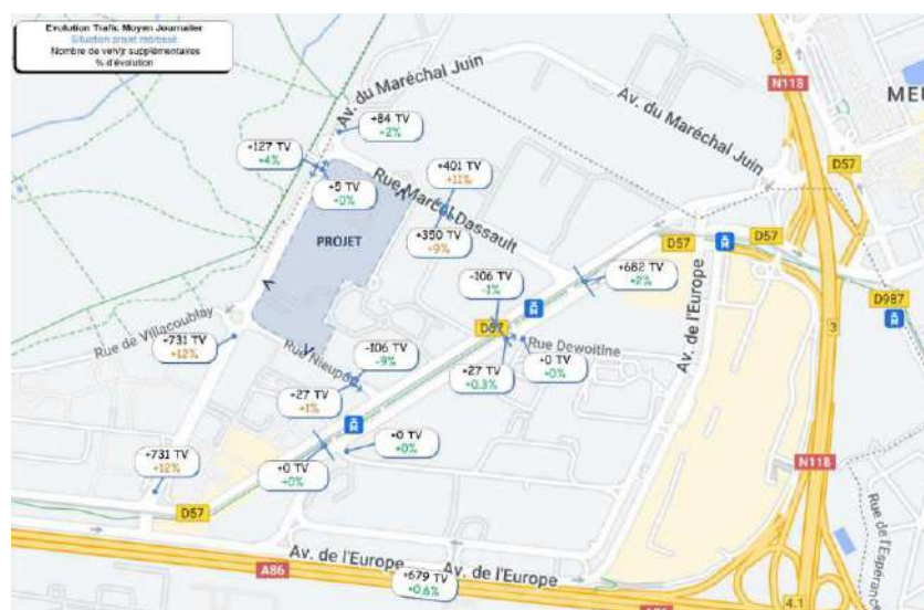
Évolution du Trafic Moyen Journalier prévisionnel du secteur en situation projet par rapport à la référence actuelle redressée (source : CDVIA, 2023)
