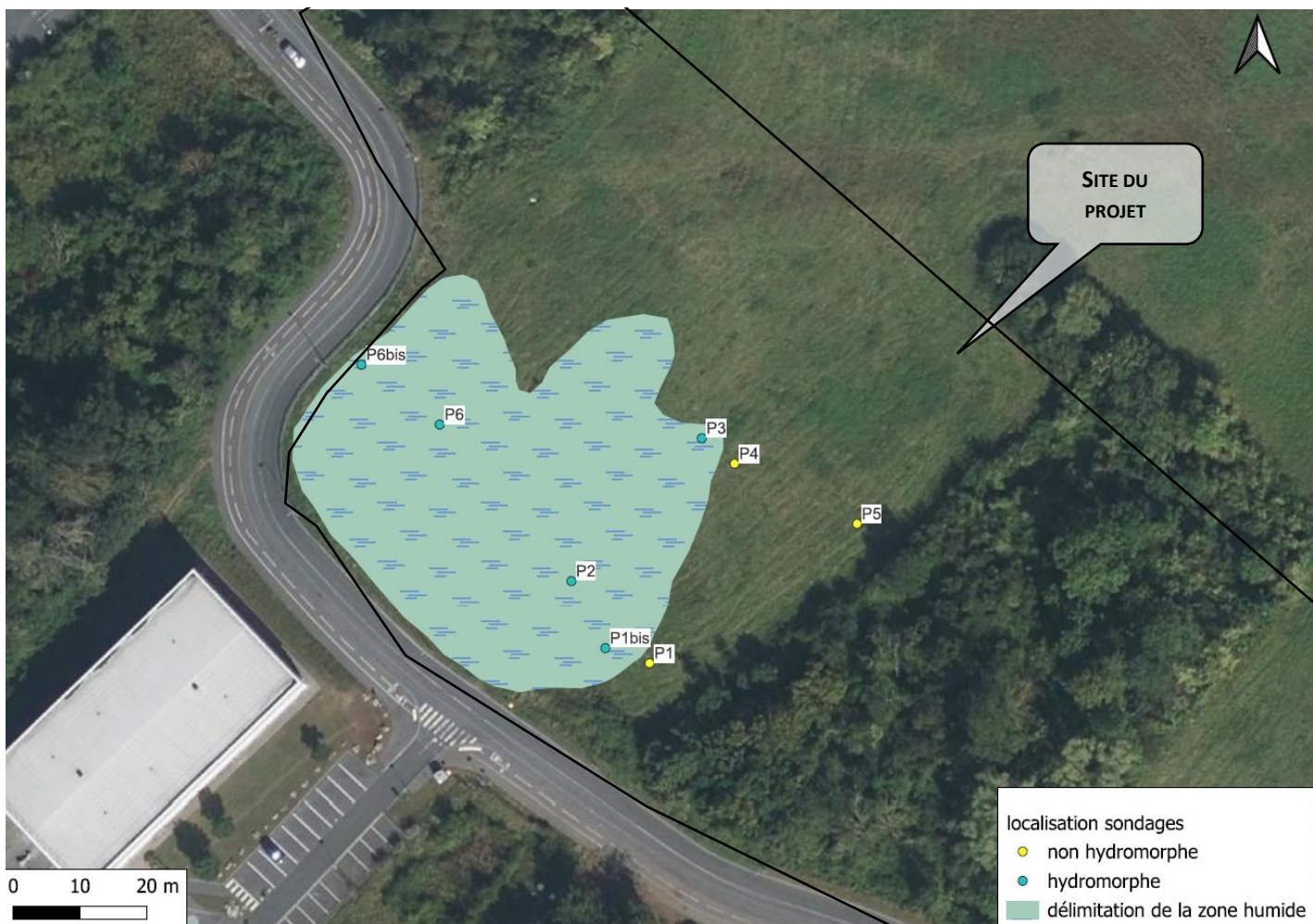
Délimitation de la zone humide, source : PCM Eau & Environnement
