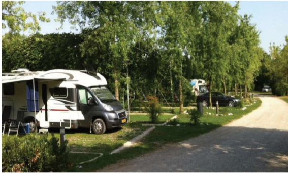
Aménagement privilégiant des traitements de sol perméables et faisant une large place au végétal. L'emprise de la voie est réduite au profit des bas-côtés herbeux pouvant supporter l'empiètement temporaire des véhicules (manœuvres ...)
