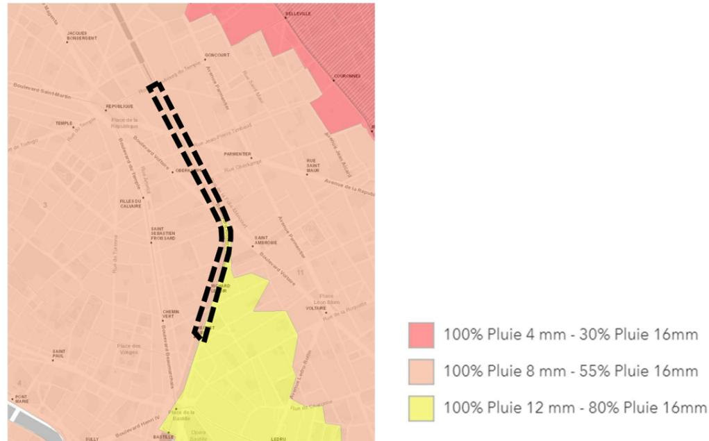
Figure 13 : Plan du zonage pluvial de Paris au niveau du projet – Source : Zonage d'assainissement Ville de Paris
