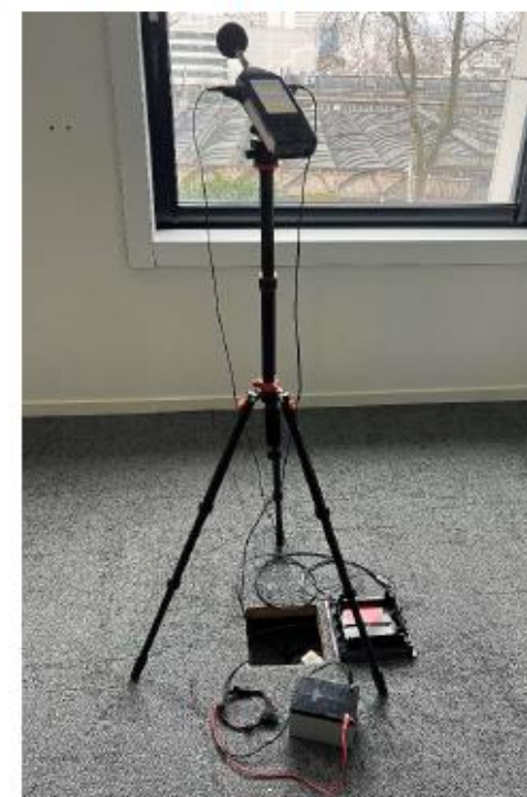
Point de mesure vibratoire longue durée face aux voies SNCF
