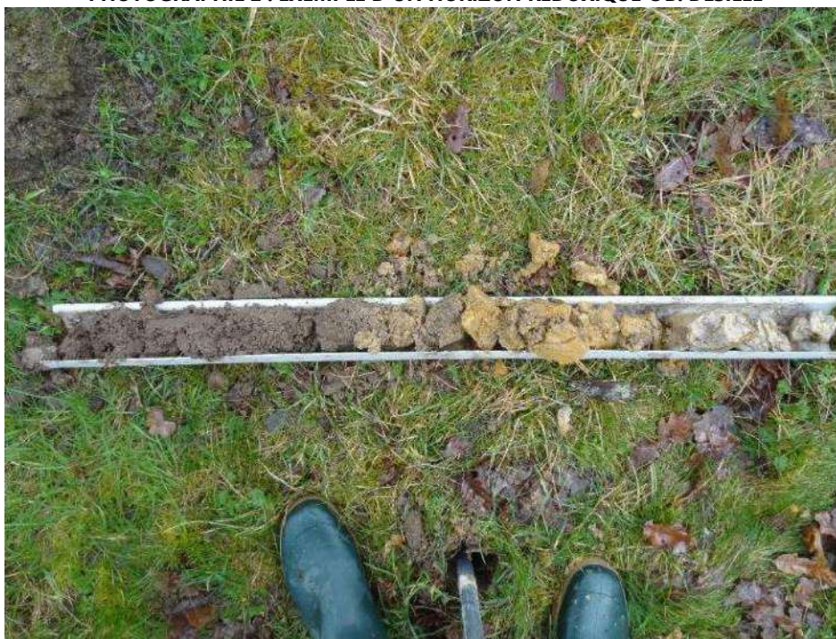
PHOTOGRAPHIE 3 : SONDAJE AVEC 3 HORIZONS VISIBLES ET DISTINCTS (NON HUMIDE EN NOIR, REDOXIQUE ET ORANGE ET REDUCTIQUE EN GRIS) ©B. DESILLE
