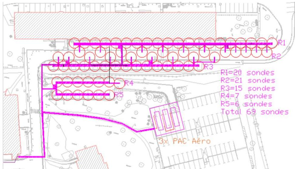
Figure 1 : Plan d'implantation des sondes géothermiques (disques rouges) et des pompes à chaleur aérothermiques (zoom sur les bâtiments K, J et Y)
