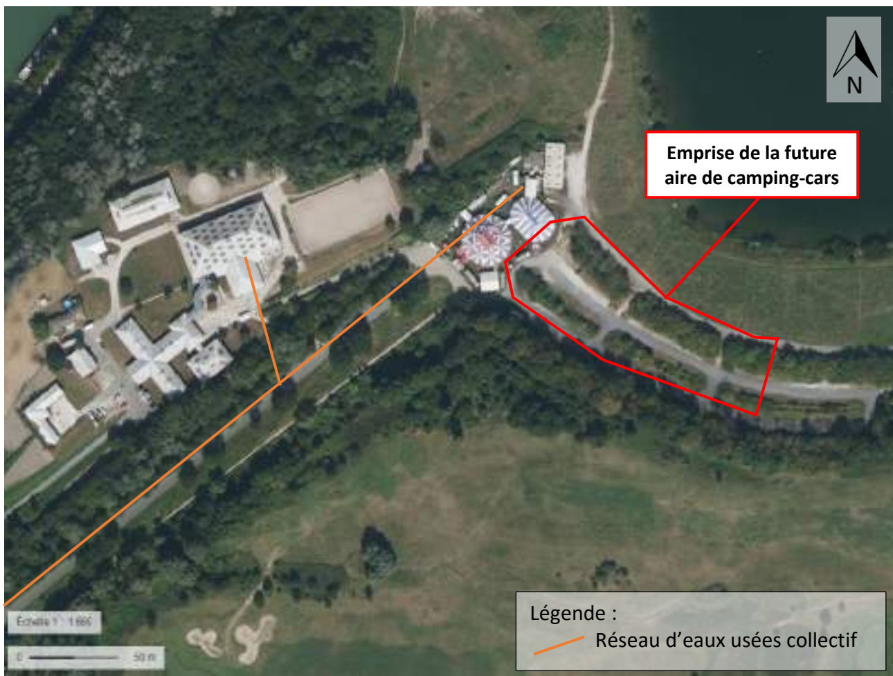
Vue aérienne de l'emprise de projet avec localisation du réseau d'eaux usées à proximité
