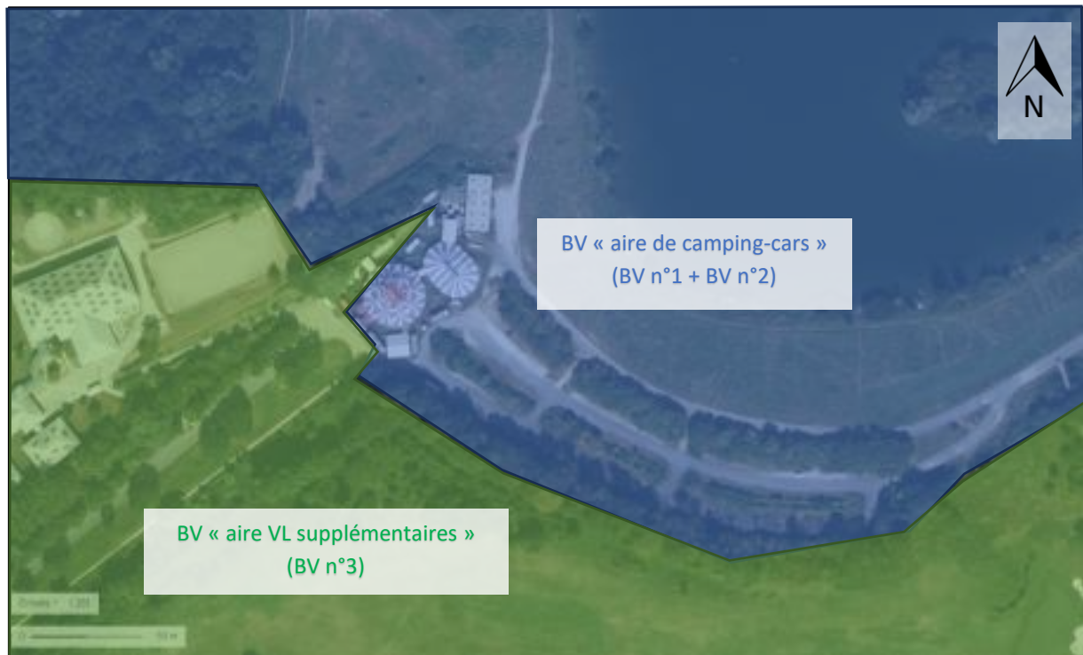
Découpage des bassins versants dans le cadre des calculs de surfaces actives
