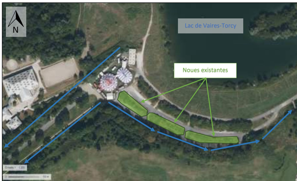
Vue aérienne de la zone du projet avec identification des fossés et des noues sur l’emprise du projet
