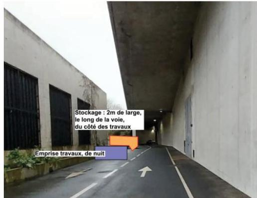
FIGURE 19 : SCHEMATISATION DE L'EMPRISE TRAVAUX
