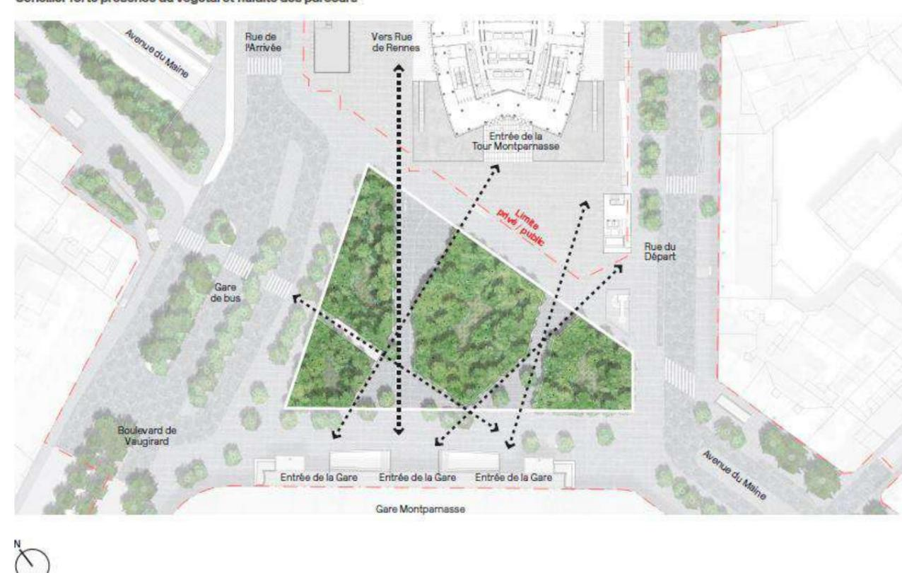
Le sous-sol de ce secteur étant particulièrement contraint (ouvrages enterrés, ouvrages RATP, tunnel du Maine, ancienne usine de ventilation, réseaux divers), l'analyse des sous-sols est déterminante afin d'assurer une épaisseur de substrat permettant de planter des arbres.
