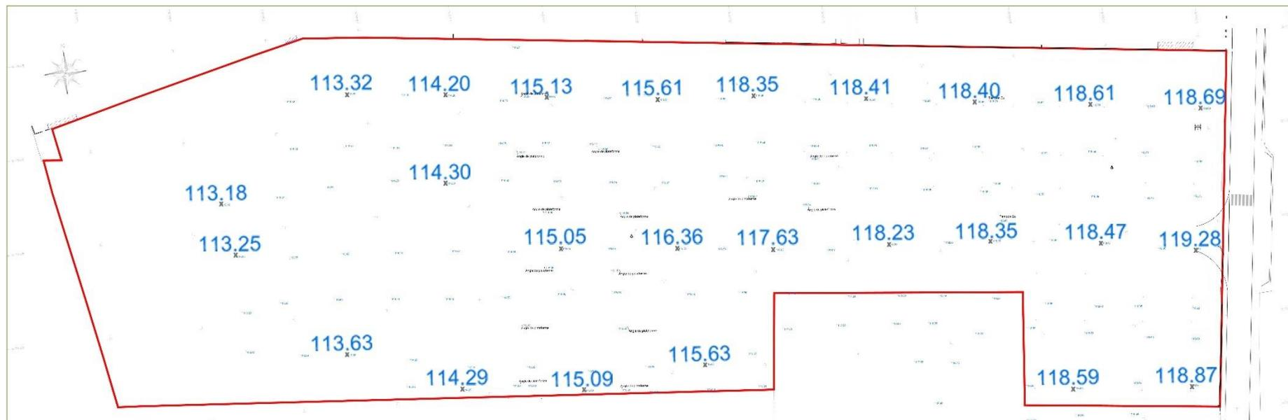
**Figure 7 : Extrait du Plan de récolement altimétrique sur l'emprise de la phase 1**
