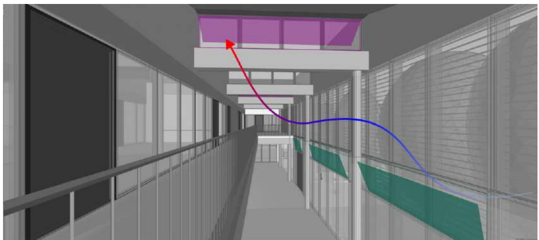
Illustration du tirage thermique dans le forum (les couleurs des ouvrants font référence aux plans de repérage page suivante)
