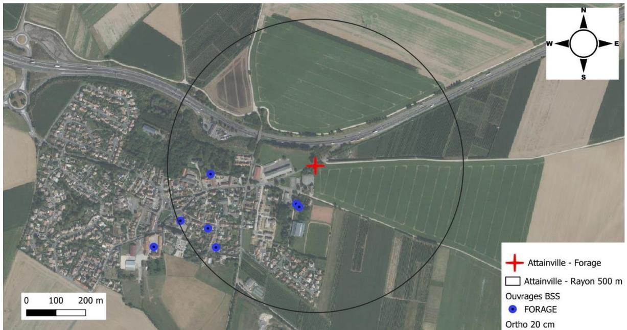
Six forages sont recensés dans un rayon de 500 m autour du projet. La BSS précise que l'un des forages est un piézomètre et qu'un des forages est rebouché.
