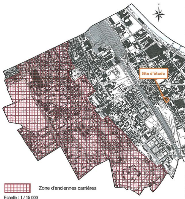
Figure 1 : Risque Mouvement de terrain par affaissements et effondrements de terrain, Ivry-sur-Seine (Source : Site Internet de la commune d'Ivry-sur-Seine)
