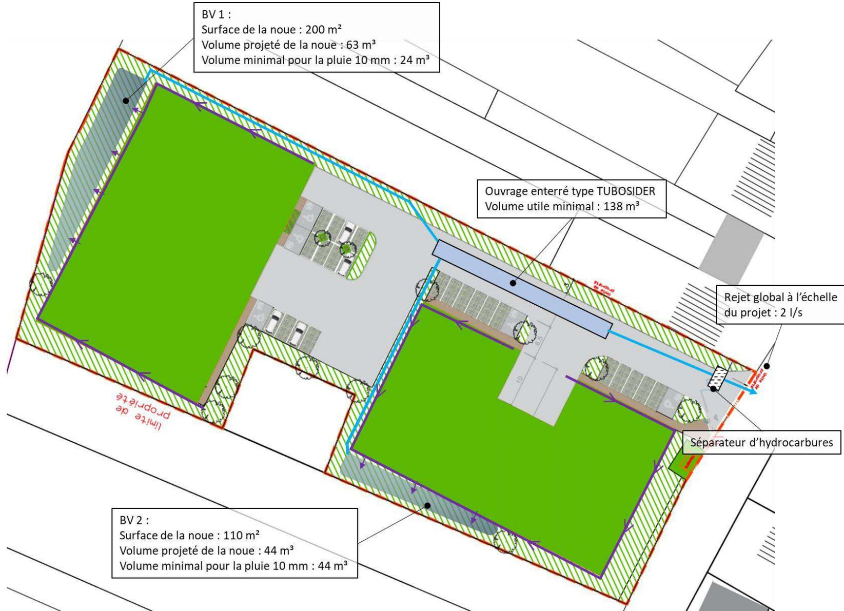
Figure 5 : Schéma de principe de gestion des eaux pluviales
