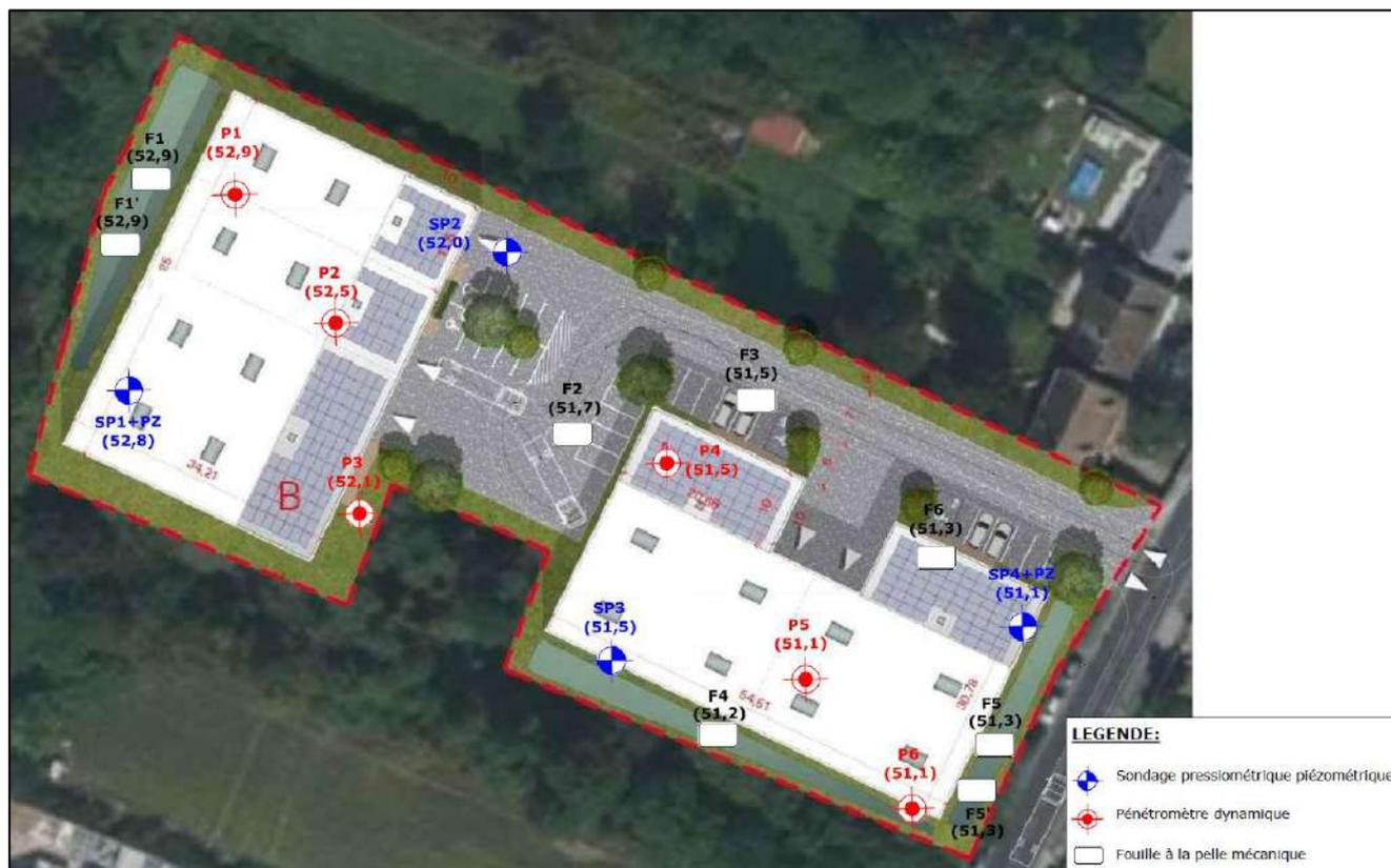
Figure 4 : Localisation des différents essais de perméabilité (ATLAS GEOTECHNIQUE, 23/01/2024)
