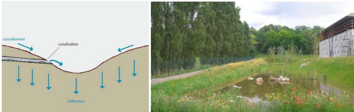
*Figure 6 - Coupe type et exemple noue végétalisée.*
