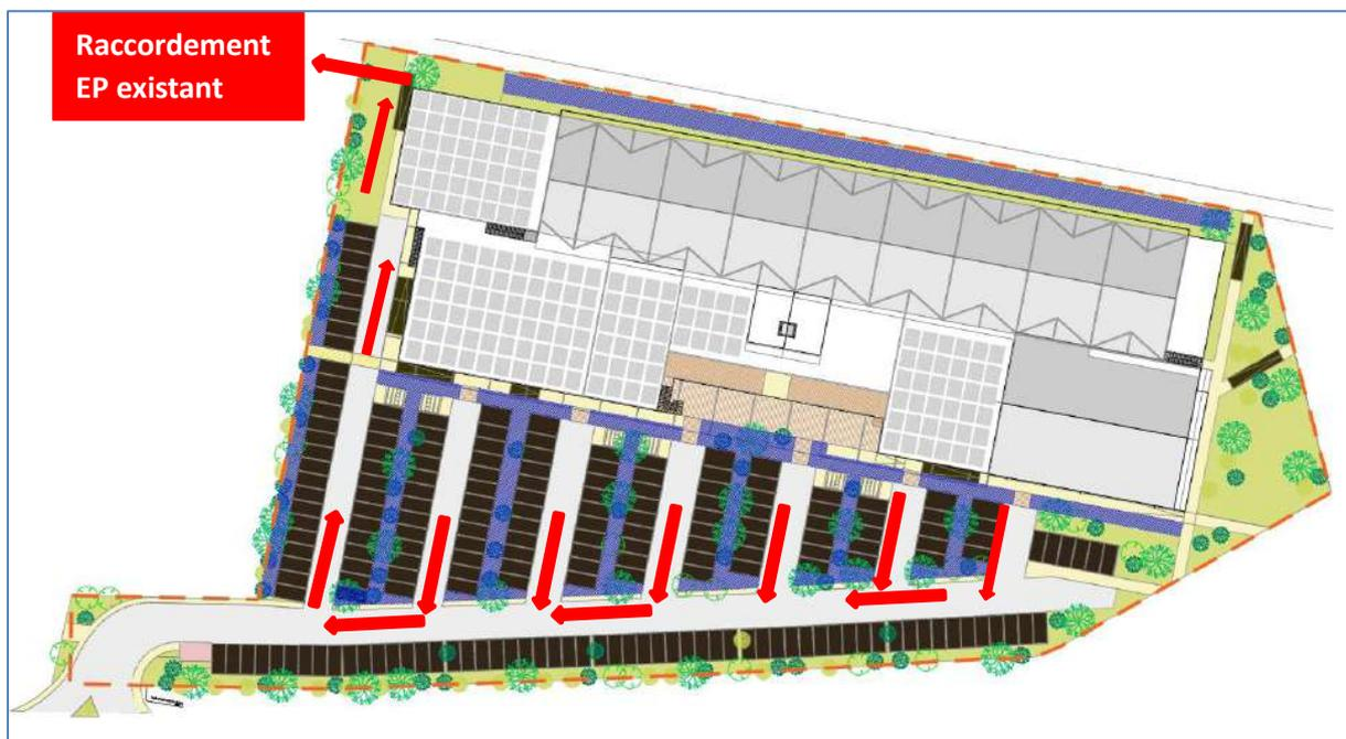
Figure 3 - Principe de la gestion des eaux pluviales chaussée.
