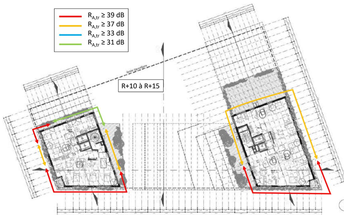
Figure 4 – Objectifs d’indices d’affaiblissement  $R_{A,tr}$  ( $R_w + C_{tr}$ ) des châssis vitrés
