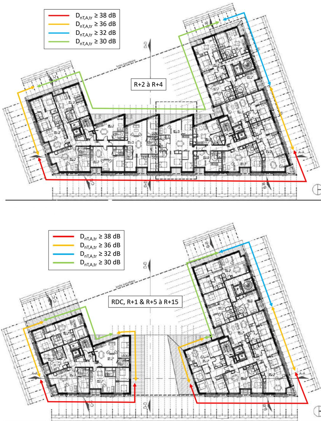
Figure 2 – Vue d'ensemble des objectifs d'isolement de façade  $D_{nT,A,tr}$
