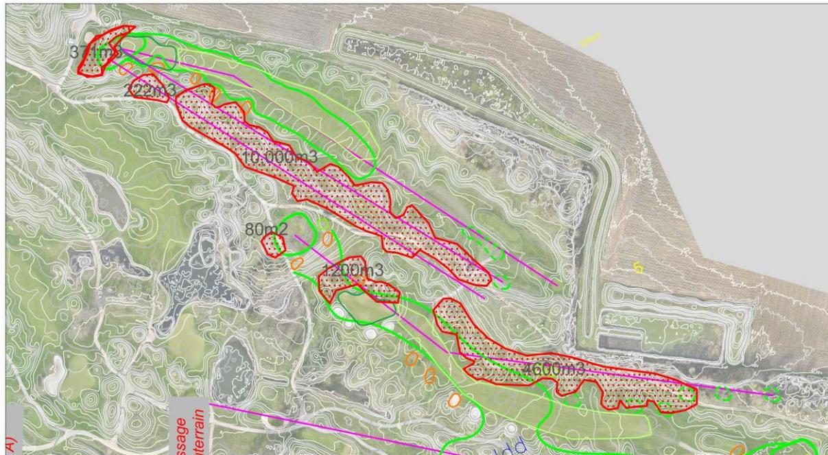
Plan représentant **les volumes de matériaux** qu'il est proposé de manipuler (**déblayer** puis remblayer) à l'intérieur de la zone rouge en pointillé, avec une profondeur moyenne d'excavation estimée à 2 mètres maximum sans **jamais descendre en dessous de l'altimétrie du terrain naturel d'origine**. Les autres zones de terrassement sont concernées uniquement par du remblai.
