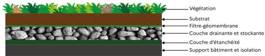
Figure 16 : Schéma d'une toiture végétalisée standard (source fiche technique du Cerema).
