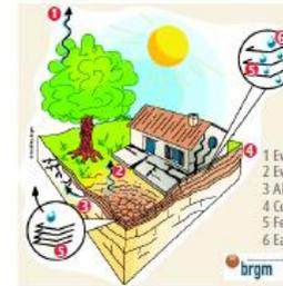
Un sol argileux change de volume selon son humidité comme le fait une éponge ; il gonfle avec l'humidité et se resserre avec la sécheresse, entraînant des tassements verticaux et horizontalement, des fissurations du sol.
