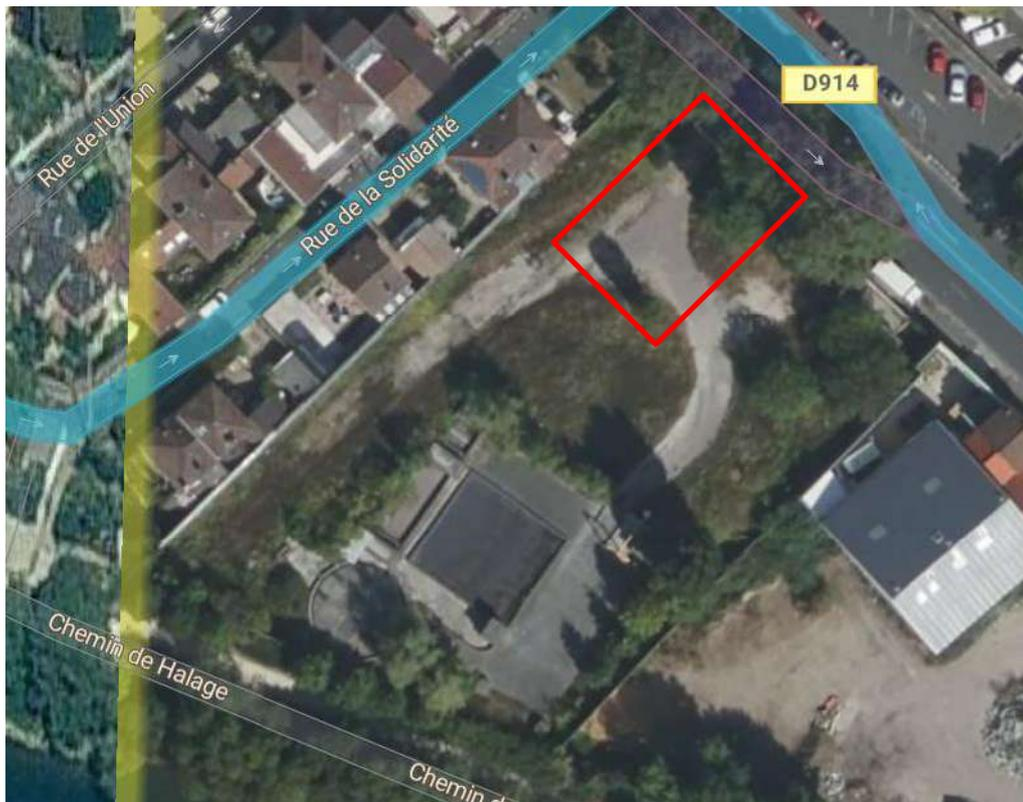
**Figure 8 : Proposition d'implantation base vie et stockage matériaux**
