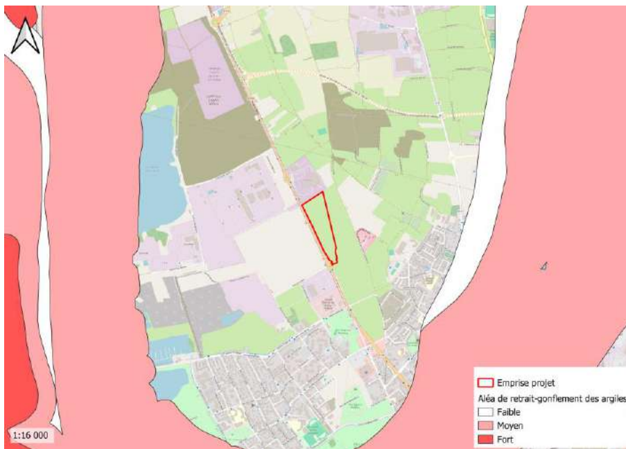
Figure 13 : Risque de retrait-gonflement des argiles @ Verdi
