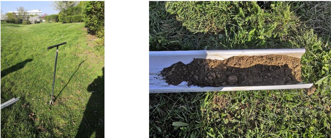
*Figure 30 : Carottage réalisé sur site au sein des espaces verts*
