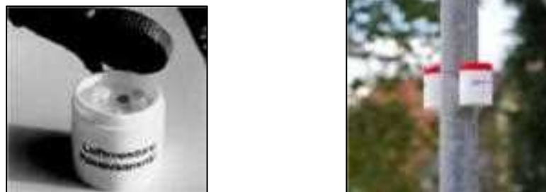
Figure 13 : installation des échantillonneurs passifs en extérieur
