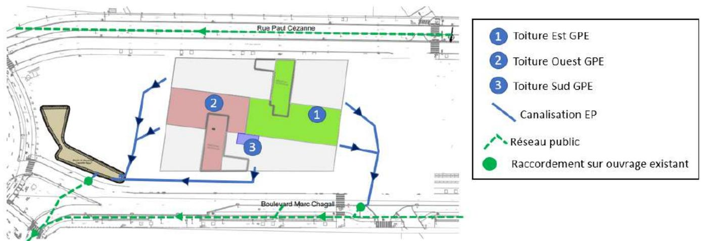
Figure 7 : Gestion des eaux pluviales - Phase 1
