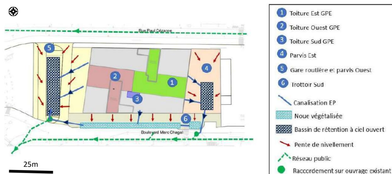
Figure 60 : Gestion des eaux pluviales en phase définitive (Source : Notice de synthèse de la gestion des Eaux Pluviales de la gare de Aulnay-sous-Bois, SGP, Mai 2022)
