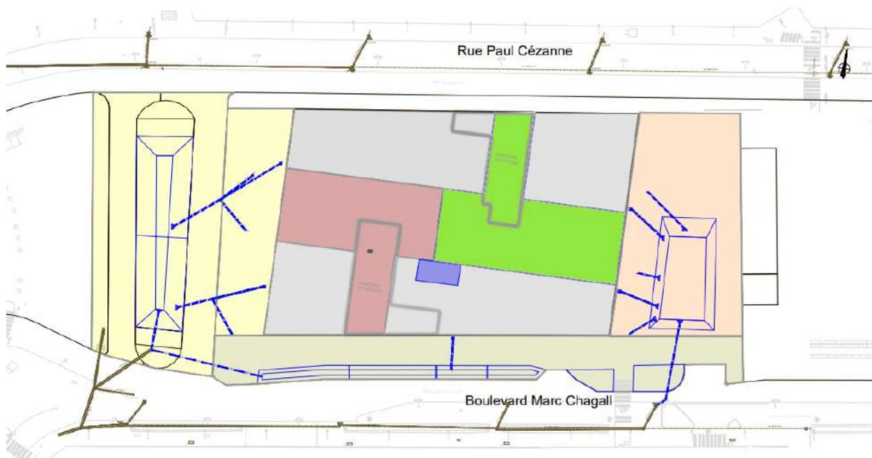
Figure 14 : Plan des réseaux d'eau pluviale - Phase 2
