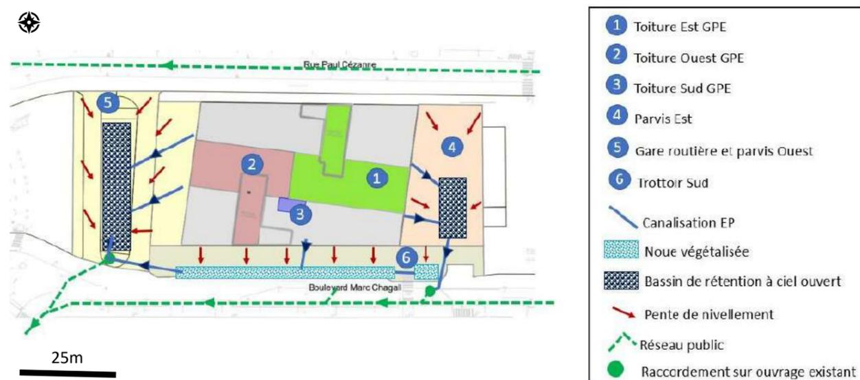
Figure 28 : Gestion des eaux pluviales en phase définitive (Source : Notice de synthèse de la gestion des Eaux Pluviales de la gare de Aulnay-sous-Bois, SGP, Mai 2022)
