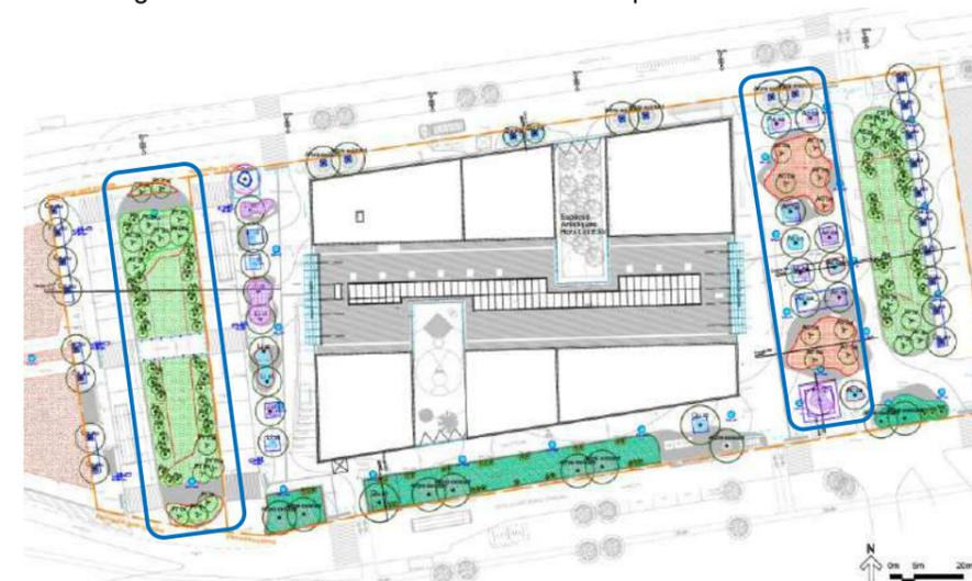
Figure 26 : Plan de repérage – les noues d'infiltration plantées (Egis, 2024)
