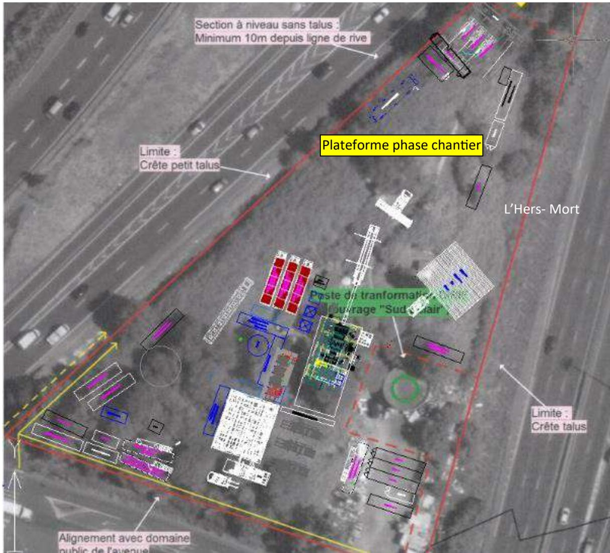
Figure 1 : Implantation d'un appareil de forage pour la phase chantier – Machine et dotation type
