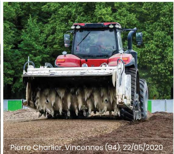
**Figure 6 : Mélange de compost et terre inerte – tracteur avec broyeur à cailloux**
