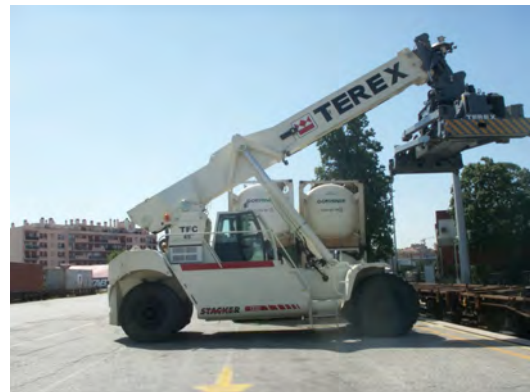
Chargement d'une caisse sur un train par un reach stacker
