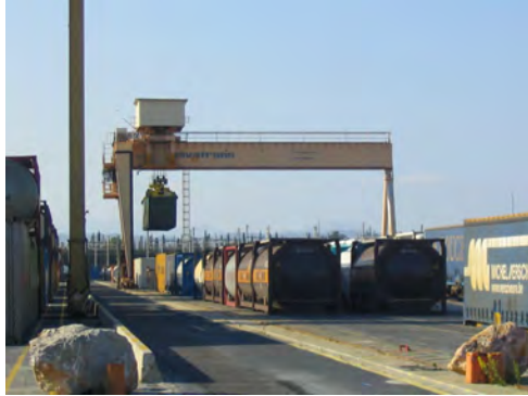
Chargement d'une caisse sur un train par un portique
