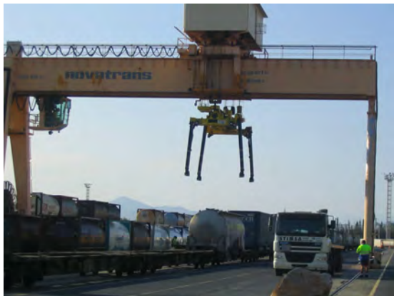
Chargement d'une caisse sur un train par un portique
