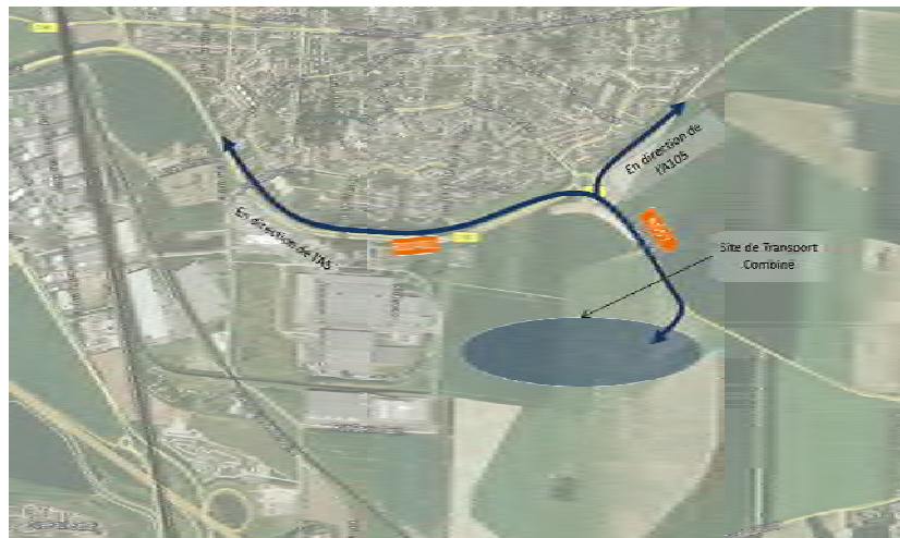
Figure 118 : Moissy-Cramayel - Création d'un accès sur la RD 57
