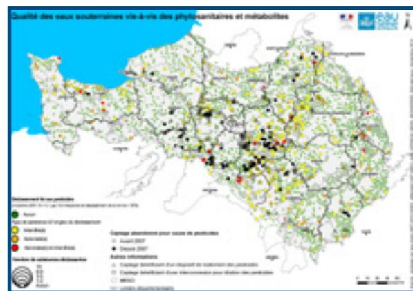
Figure 17 : Qualité des eaux souterraines au point de mesure vis-à-vis des phytosanitaires et leurs produits de dégradation [résultats de surveillance de 2007 à 2010] et les captages abandonnés pour cause de dégradation par les pesticides.
