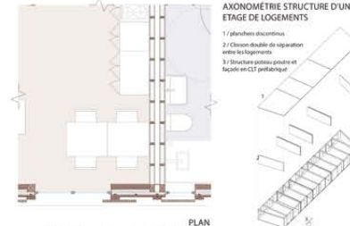
PLAN CLOISON DOUBLE TECHNIQUE ET ACROUSTIQUE ENTRE CHAQUE LOGEMENT
