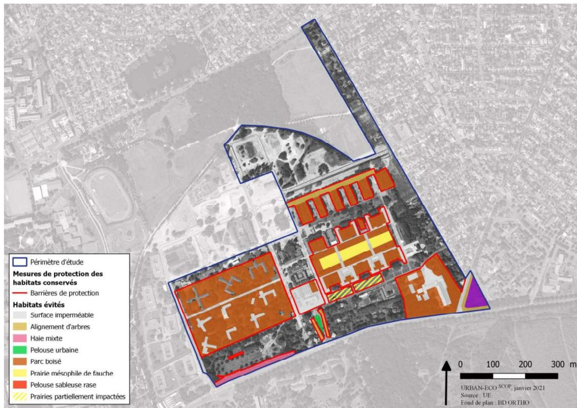
Figure 133. Localisation des clôtures de protection à implanter pendant les travaux d'aménagements (URBAN-ECO<sup>SCOP</sup>, 2021)
