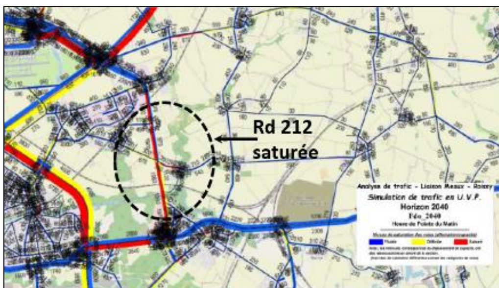
Figure 11 : charge de trafic horizon 2040 fil de l'eau - Heure de pointe du soir (source CD 77)
