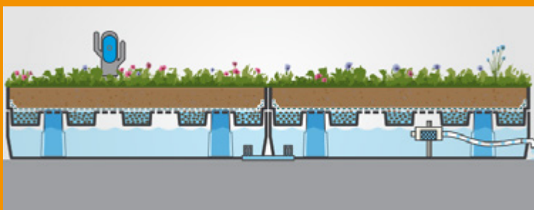
Toiture végétalisée avec stockage et débit régulé (Exemple Hydroventiv® - Le Priéuré)
