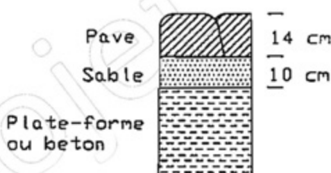
COUPE TYPE D'UNE STRUCTURE DE VOIRIE AVEC PAVÉS D'ÉCHANTILLON DE REMploi DE 14 CM.
