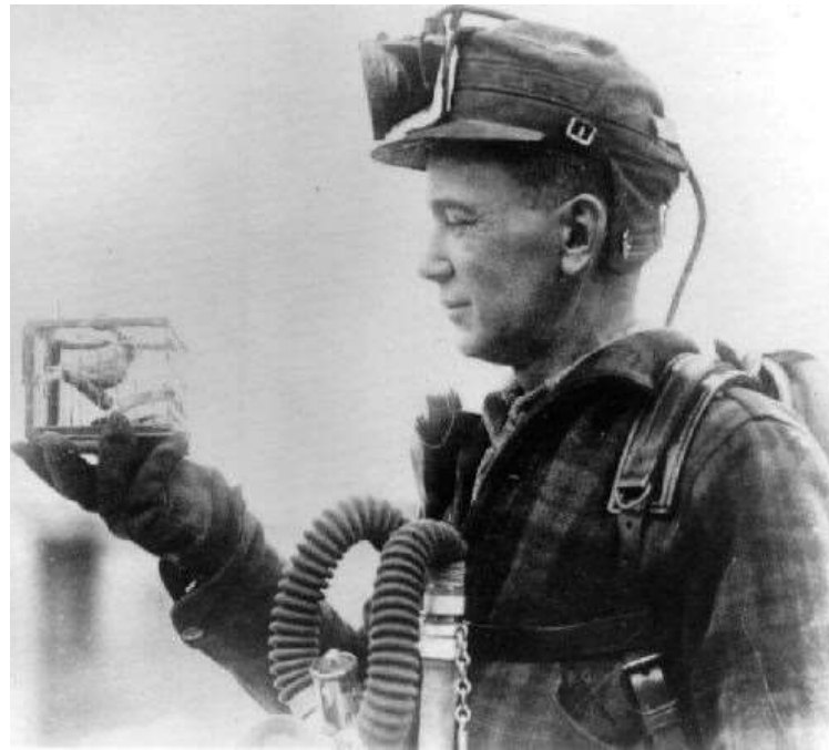
Canari « détecteur » de monoxyde de carbone dans les mines au début du 20e siècle
