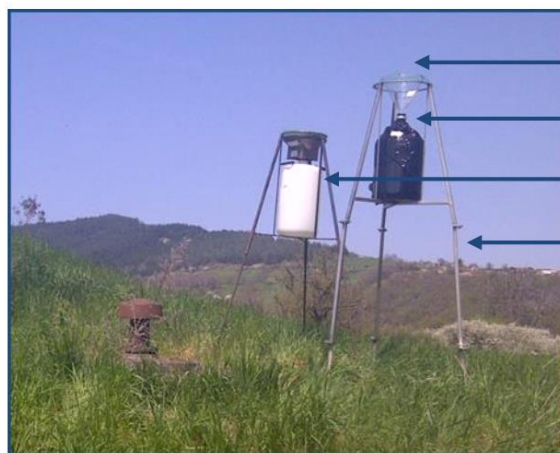
Entonnoir Jauge en verre protégée de la lumière Jauge en plastique Support métallique
