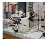
NO 2 - : Essais en continu sur boucle d'échantillonnage - sonde/analyseur VS laboratoire
