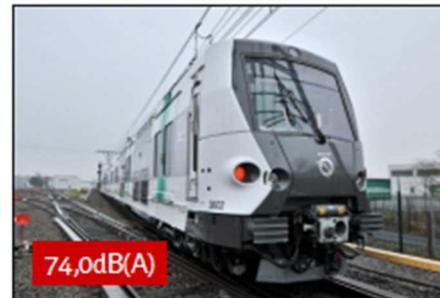
*Niveaux sonores, en dB(A), des divers matériels roulants circulant ou ayant circulé sur le RER A, à 80km/h et à 7,5m de l'axe de la voie (NF EN ISO 3095).*
